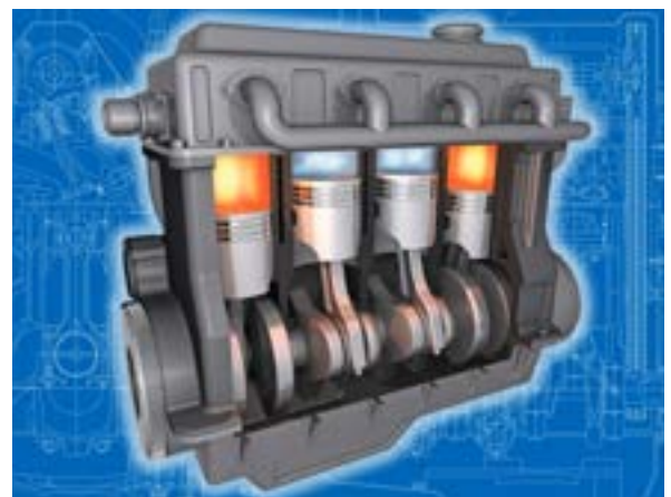
Abbildung 9: Verbrennungsmotorsimulation für die Berechnung des elasto-hydrodynamischen Drucks
